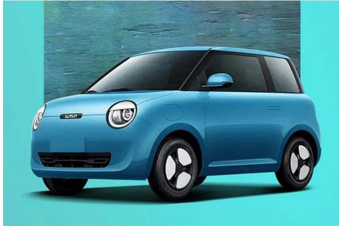
新车基于 EPA0 平台打造,整体造型依旧走的是呆萌路线。新车的长宽高分别为 3270mm/1700mm/1545mm,轴距为 1980mm。新车驱动电机有两种供应商版本,最大功率都为 30kW,预计配备中创新航的磷酸铁锂电池,并提供 155km 和 210km 两个续航版本。
