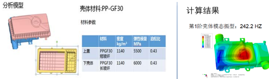
图（8）空气滤清器模态分析
