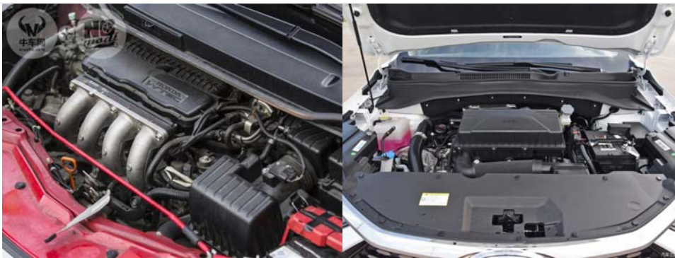
图(1) 空气滤清器布置位置示意图
