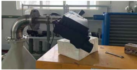
图(10)对空气滤清器进行进气阻力试验
