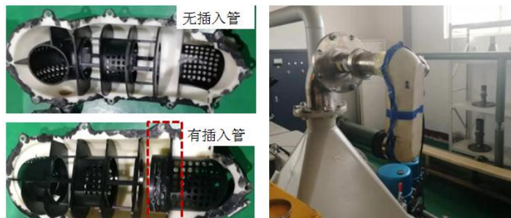
图 11: 消音器内部扩张腔增加插入管对比和阻力测试图
