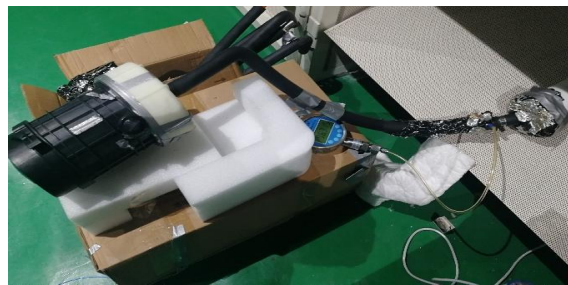
图 14: 空滤阻力测试图
